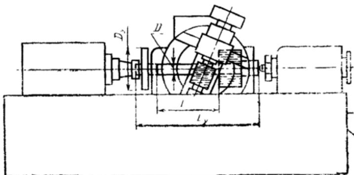
$D$  — наибольший диаметр обрабатываемого колеса прямозубого);
