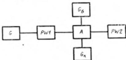
*G* генератор переменного сигнала; *Pw1*—измеритель входной мощности; *G<sub>b</sub>*, *G<sub>k</sub>* — источники питания постоянного напряжения; *A*—контактное согласующее устройство с измеряемым транзистором; *Pw2*—измеритель выходной мощности
