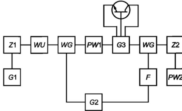
$G1$  — генератор возбуждения;  $Z1, Z2$  — фильтры;  $WU$  — развязывающее устройство;  $WG$  — ввод питания;  $PW1$  — измеритель проходящей мощности;  $G3$  — измерительный генератор;  $PW2$  — измеритель мощности;  $G2$  — блок питания транзистора;  $F$  — блок защиты
