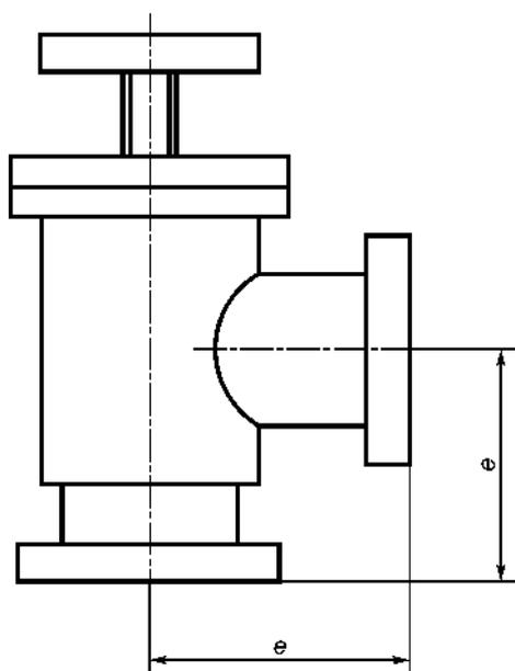
$e$  — установочный размер от оси условного прохода клапана до стыковочной поверхности фланца (размер кромки)
