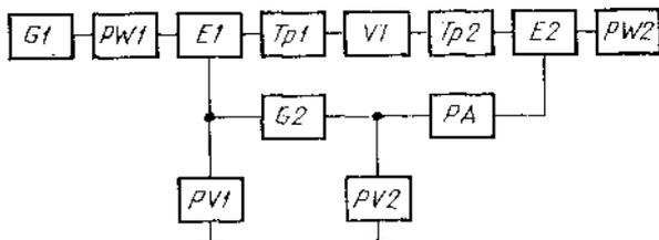
*G1*—генератор возбуждения; *PW1*—измеритель проходящей мощности; *E1*, *E2*—вводы питания; *Tr1*, *Tr2*—согласующие трансформаторы; *G2*—блок питания транзистора; *VT*—измеряемый транзистор с контактодержателем; *PW2*—измеритель выходной мощности; *PA*—измеритель постоянного тока стока; *PV1*, *PV2*—измерители постоянного напряжения на стоке и затворе
