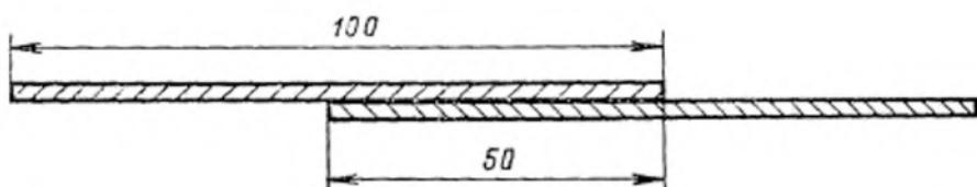
4.2. Каждую пару сложенных образцов кладут между двумя стеклянными пластинками толщиной 2,0—3,0 мм и размером  $100 \times 100$  ( $\pm 2$ ) мм, нагружают грузом 1 кгс, помещают в термостат, в котором установлена температура  $60 \pm 2$  или  $70 \pm 2^\circ\text{C}$ , и выдерживают в термостате в течение 1 ч. Образцы помещают в термостат на ровную, непрогибающуюся полку. Груз и стеклянные пластины должны быть предварительно прогреты не менее 2 ч до температуры испытания.
