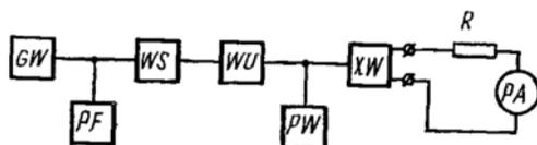
*GW*—генератор СВЧ мощности; *PF*—частотомер; *WS*—ферритовый вентиль; *WU*—переменный аттенюатор; *PW*—измеритель мощности; *XW*—измерительная диодная камера; *R*—добавочный резистор; *PA* — миллиамперметр.
