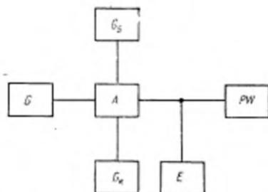
$G$ —генератор двухтонового сигнала;  $G_2$  и  $G_k$ —источники для задания режима питания по постоянному току входной и выходной цепей транзистора;  $A$ —контактное согласующее устройство с измеряемым транзистором;  $PW$ —измеритель мощности;  $E$ —анализатор спектра сигнала в нагрузке
