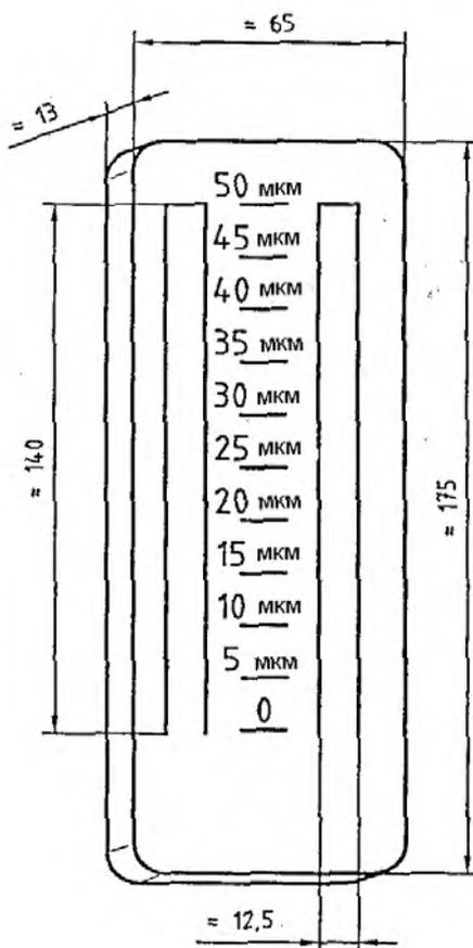
Рисунок 1 – Типовой прибор (*грудометр*)
