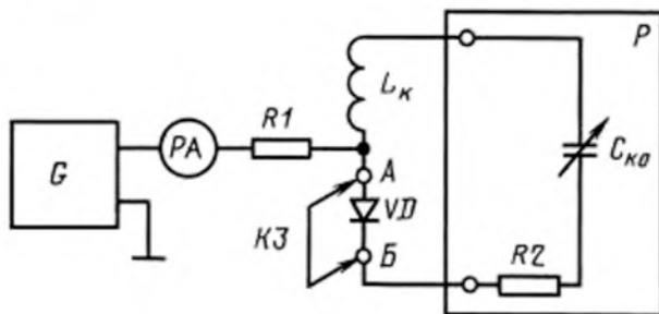
*G* — блок смещения; *PA* — миллиамперметр; *R1* — резистор подачи смещения; *L<sub>k</sub>* — катушка индуктивности, подключаемая к куметру; *P* — куметр; *C<sub>k0</sub>* — переменный конденсатор куметра; *R2* — резистор внутри куметра, на котором создается ЭДС высокой частоты, *VD* — измеряемый диод; *K3* — замыкатель
