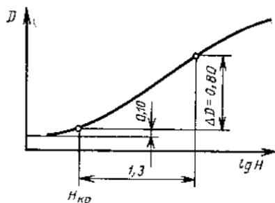
4. Общую светочувствительность фотографической пленки ( $S$ ) вычисляют при экспозиции  $H_{kp}$ , соответствующей плотности  $D=0,1+D_{min}$ , по формуле
