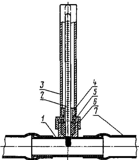
1 — тройник; 2 — термометр; 3 — кожух; 4 — гайка;
