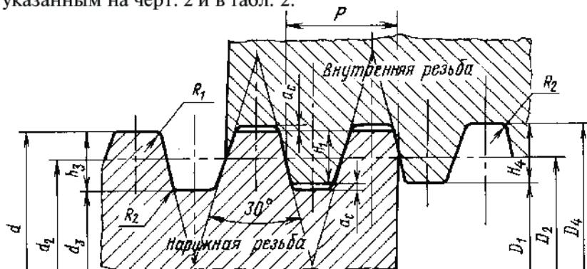
$h_3$  — высота профиля наружной резьбы;  $H_4$  — высота профиля внутренней резьбы;
