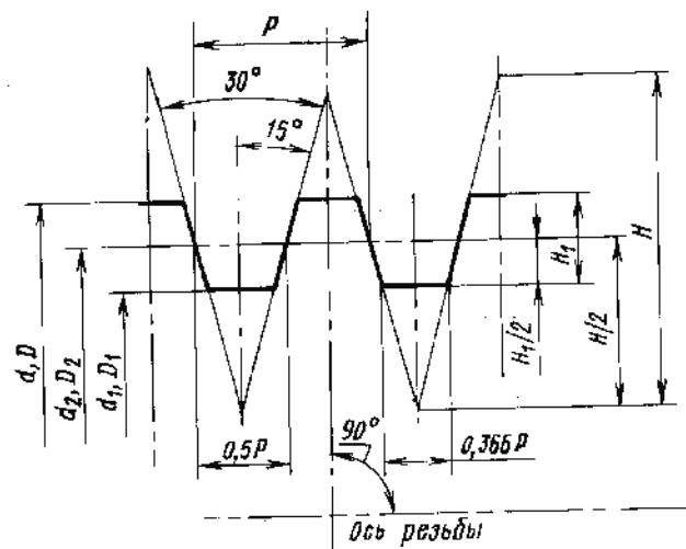
$d$  — наружный диаметр резьбы (винта);  $D$  — наружный диаметр внутренней резьбы (гайки);  $d_1$  — средний диаметр наружной резьбы;  $D_1$  — средний диаметр внутренней резьбы;  $d_2$  — внутренний диаметр наружной резьбы;  $D_2$  — внутренний диаметр внутренней резьбы;  $P$  — шаг резьбы;  $H$  — высота исходного треугольника;  $H_1$  — рабочая высота профиля
