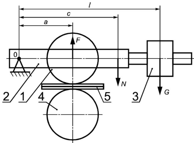
*l* — прижимной ролик; 2 — прижимная рамка; 3 — дополнительный груз; 4 — ведущий ролик; *F* — сила прижима лент; *N*, *G* — соответственно сила веса прижимной рамки 2 и груза 3; *a*, *c*, *l* — плечи соответствующих сил; 5 — элементарная проба
